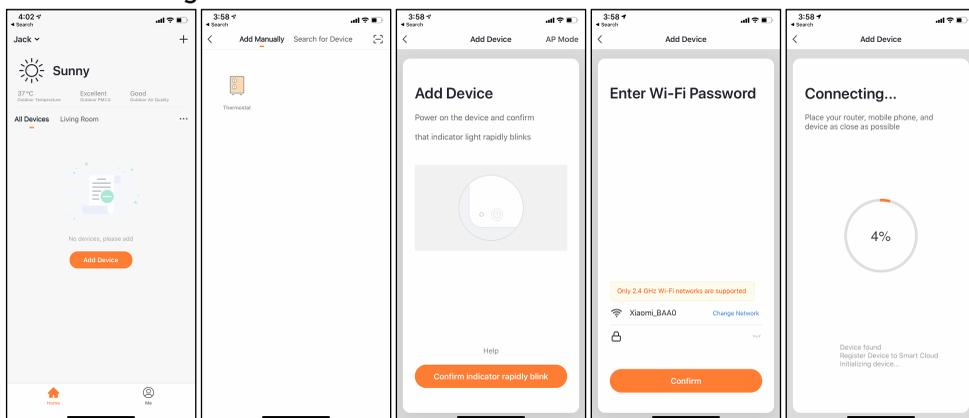
**Schritt 1:** Drücken Sie die Ein / Aus-Taste. Das WIFI-Signal beginnt schnell zu blinken. Öffnen Sie die APP auf Ihrem Smartphone und fügen Sie Ihr Gerät hinzu. Wählen Sie dazu "Gerät hinzufügen", dann "Manuell hinzufügen" und dann "Thermostat", um das Gerät hinzuzufügen.
